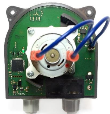
Rückansicht der Pumpe mit Platine. Links der DSP, rechts Motortreiber und unten zwei RJ45 Buchsen für Spannungsversorgung und Kommunikation.
